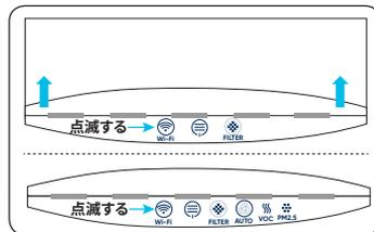
天面のカバーを開き、運転スピードボタンを押します。Blueair Friendアプリと連動させるには、Wi-Fiマークが点滅するまで待ってください。
