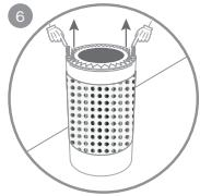
拉住主濾網的兩側把手後向上拉起，將主濾網從空氣清淨機內移除。
