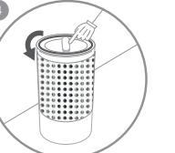
小心地將本空氣清淨機上下顛倒放置在平坦的表面上，接著一手扶妥本空氣清淨機，另一手以逆時針方向轉動底蓋。
