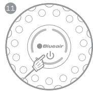
按壓觸控按鈕持續5秒鐘，濾網汰換指示燈將閃爍，閃爍由紅色LED燈轉至白色LED燈後，即完成重置濾網汰換計時。
